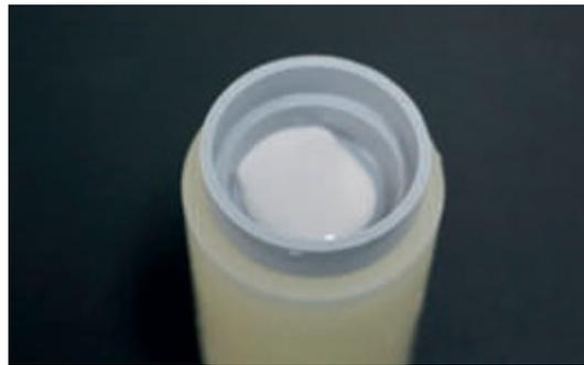
Posicione a tampa do anel de modo a manter paralelas as superfícies do topo e da base.
