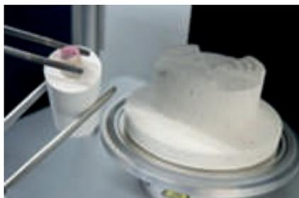
Posicione a pastilha VINTAGE PRIME PRESS no anel de revestimento quente com a marca da cor virada para cima.
