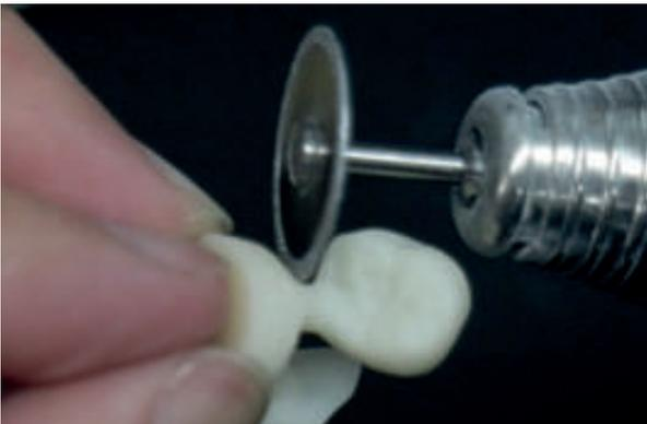
Use um disco diamantado fino em velocidade baixa para cortar os sprues
