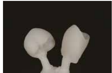
Objetos completamente desincluídos após a desinclusão fina com \text{Al}_2\text{O}_3 , sob pressão de aprox. 0,1-0,2 MPa (1-2 bar)
