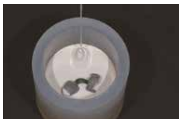
Evitar a formação de bolhas de ar durante o preenchimento do anel com o material de revestimento
