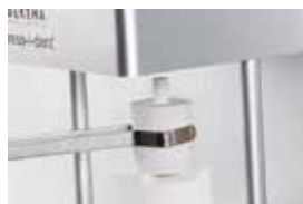
Posicionar o anel de revestimento concluído no centro do forno de prensagem pré-aquecido
