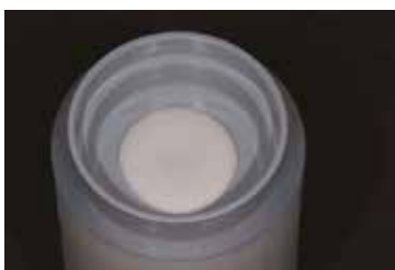
Posicionar a tampa no topo do anel, para manter paralelas as superfícies superior e inferior do anel
