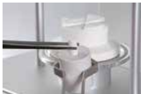
A seguir, posicionar o êmbolo descartável dentro do anel de revestimento quente
