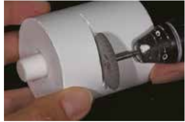
Recortar o anel de revestimento com o auxílio de um disco de corte
