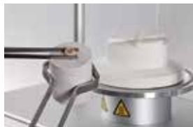
Posicionar a pastilha VINTAGE LD Press no anel de revestimento quente com a marcação da cor voltada para cima
