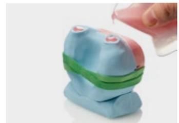
15. O vazamento está completo quando a resina goteja no canal oposto
