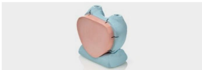
7. Construção de base em Platinum 95 para manter a estrutura em posição vertical, marcação de pontos de orientação para verificar o reposicionamento correto do silicone
