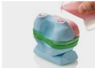
13. O vazamento está completo quando a resina goteja no canal oposto
