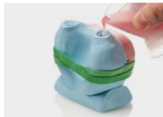
14. Vaze a resina em um dos dois canais de vazamento
