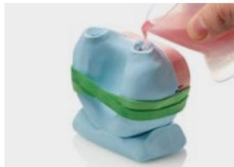
12. Vaze a resina em um dos dois canais de vazamento
