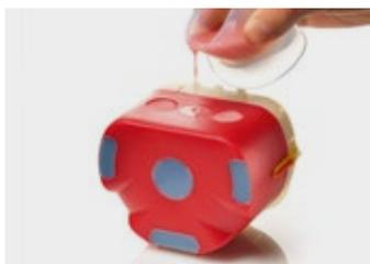
13. O vazamento está completo quando a resina goteja nos canais laterais
