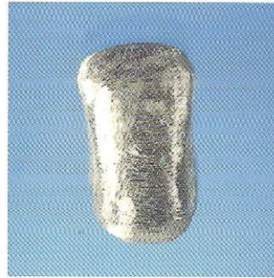
Acabamento do metal com uma pedra de granulação grossa
