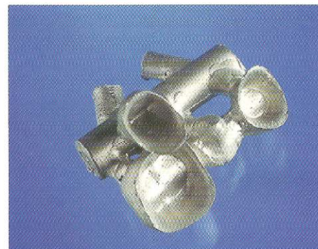
Peça fundida após a remoção do revestimento
