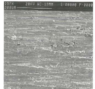
Acabamento do metal com uma pedra de granulação média
