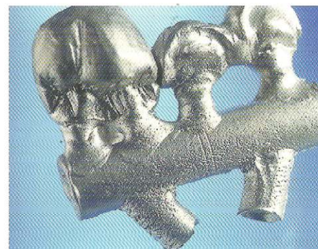
Porosidade localizada na barra de distribuição
