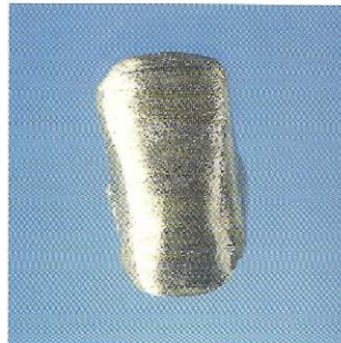
Acabamento do metal com uma pedra de granulação média
