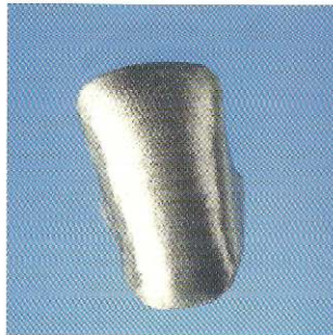
Acabamento do metal com uma pedra de granulação fina
