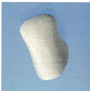
Peça jateada com óxido de alumínio com 50 µm
