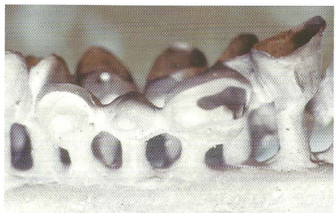
Solidificação com preenchimento incompleto do molde
