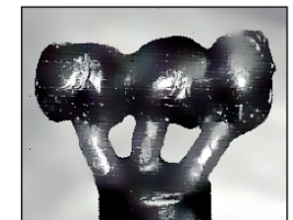
Modelo de colocação dos sprues para cerâmica prensada (exemplo de prensagem de cerâmica sobre coping de zircônia)
