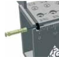
Note que há dois sulcos que auxiliam no posicionamento do cursor no comprimento necessário (adequado para destros e canhotos).
